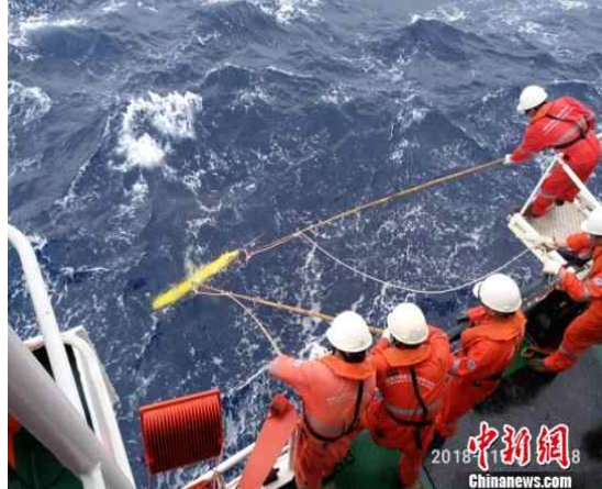
그림2 ‘하이이1000’ 글라이더를 회수하는 모습
